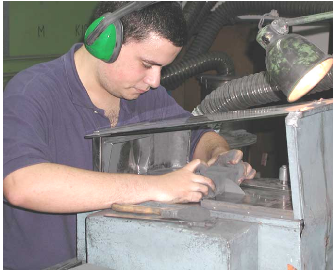
Abbildung 5: Arbeitsplatz zum Schneiden gesinterter Werkstücke
